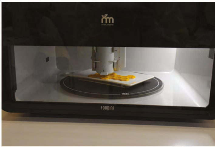
Fotografía de cómo imprime la comida la impresora Foodini de la empresa Natural Machines.
